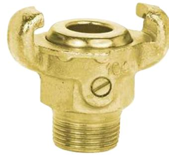
Aus Temperguss, verzinkt, gelb chromatiert, mit Außengewinde und Halteschraube. Messingdichtung - ölbeständig.
