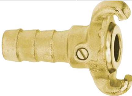
Aus Temperguss, verzinkt, gelb chromatiert, mit Schlauchtülle und Halteschraube. Messingdichtung - ölbeständig.
