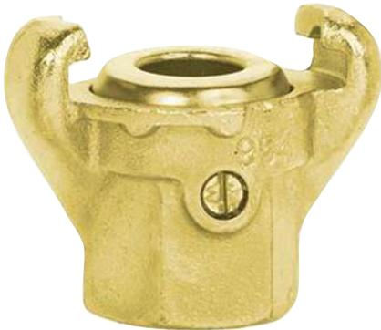
Mit Doppelnocken, Nockenweite 42 mm, PN 10 bar. Aus Temperguss verzinkt, gelb chromatiert, mit Innengewinde und Halteschraube. Messingdichtung - ölbeständig.
